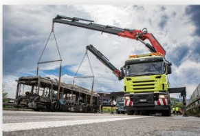
LKW- und Busbergung mit Kran, Seilwinden und Luftkissen
